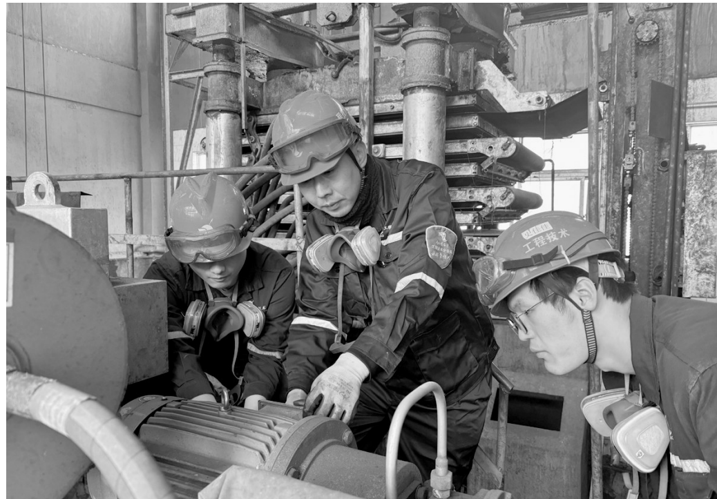
图为孔晔(中)正在检修金冠铜业双闪硫酸净液压滤机。
