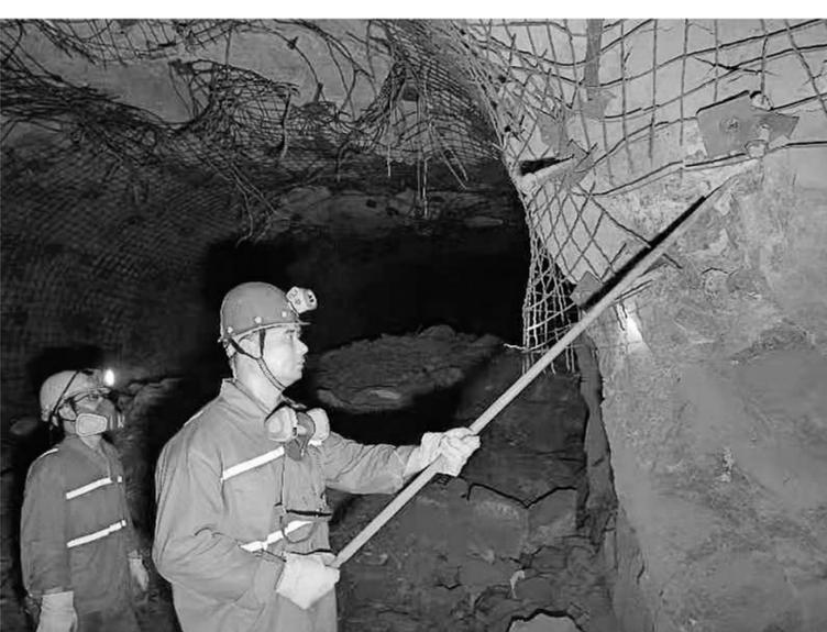
图为吴魁(前)在井下负930米中段62-14号采场,作业前对顶板板检查安全确认。
