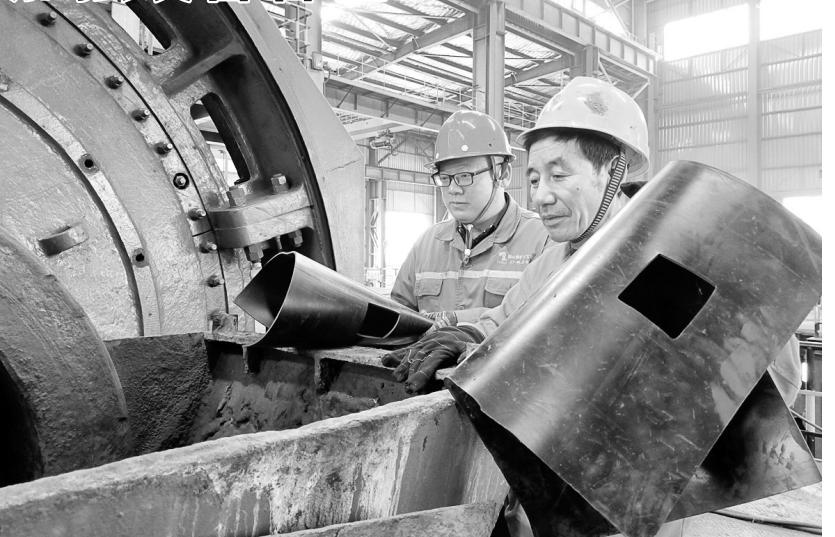
铜山铜矿分公司着力加强设备管理,确保设备正常运行,奋力冲刺全年安全生产目标,促进企业和谐稳定发展。图为近日该矿业分公司技术人员在检修球磨机。
