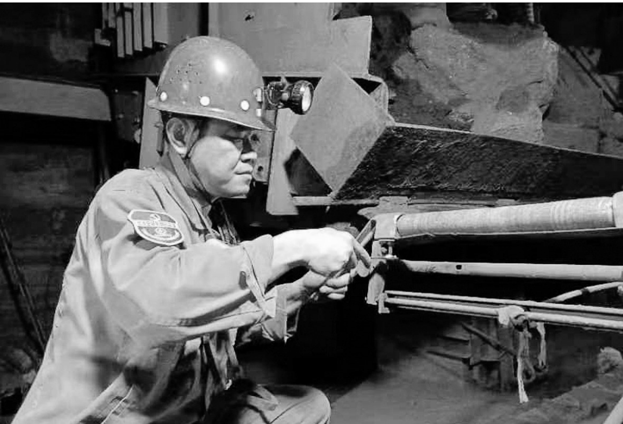
图为孙晓强在对运输电机车接电弓进行调整的场景。
