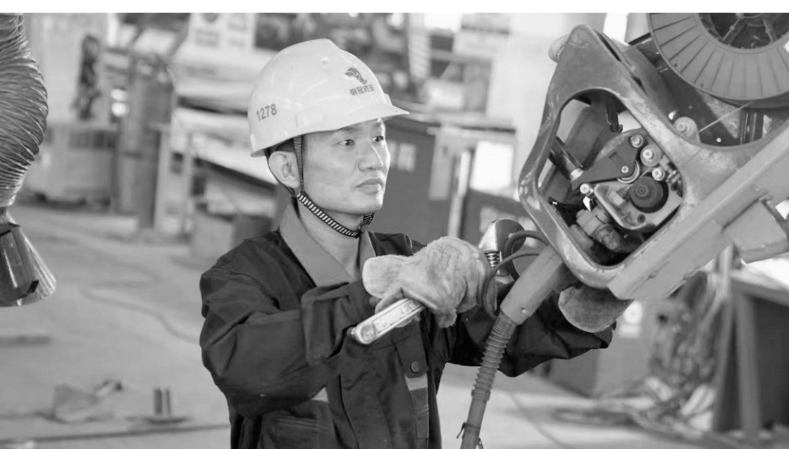
图为宣柱久正在对技改后的气保焊送丝机进行调试。
