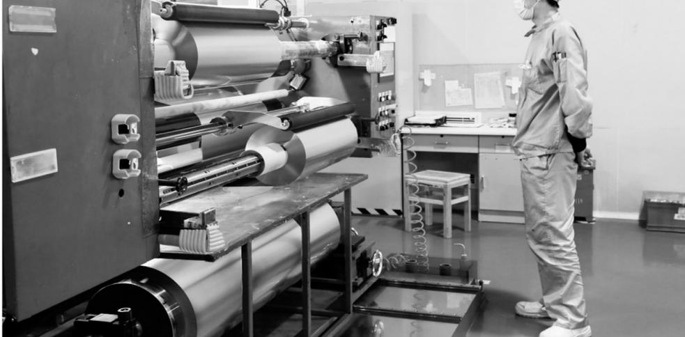
铜陵铜箔公司员工日前正在进行锂电箔分切作业。该公司今年以来积极强化锂电箔生产销售,着重调整客户结构,加快数码电优质客户以及国际锂电客户的开发力度,紧盯汽车动力电池、小动力电池、数码电、储能等细分市场,不断拓宽销售渠道,增强抗风险能力。
