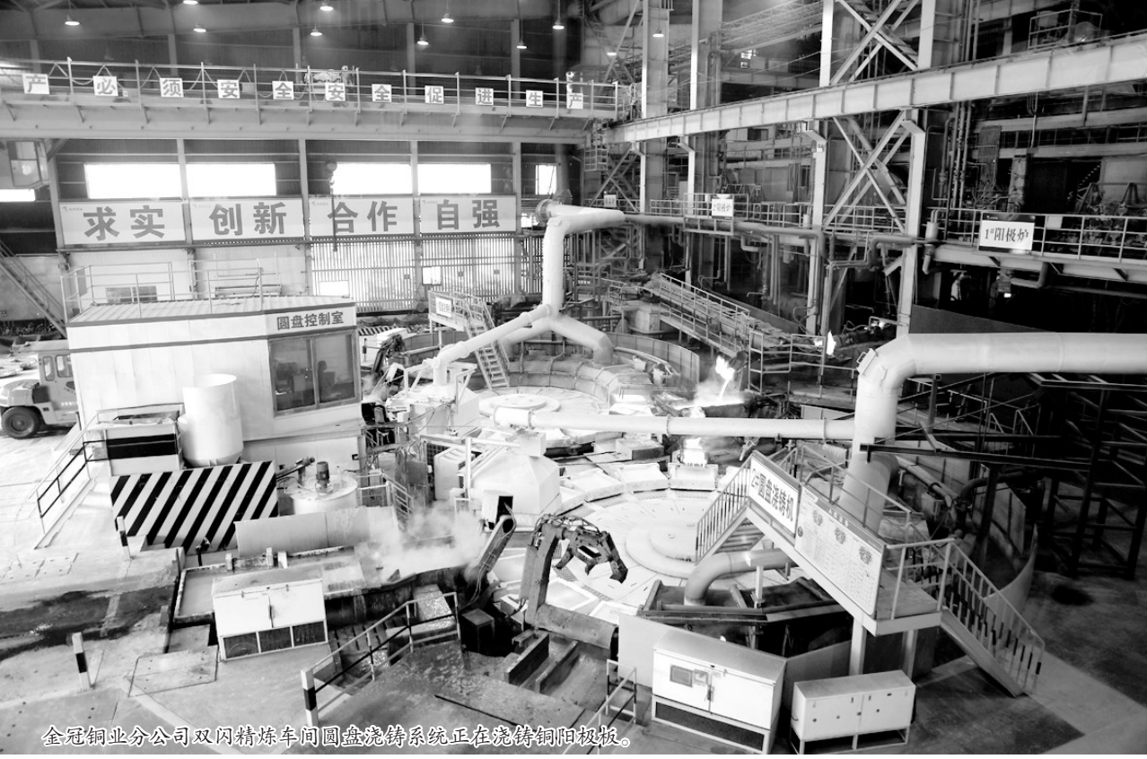
金冠铜业分公司双闪精炼车间圆盘浇铸系统正在浇铸铜阳极板。
