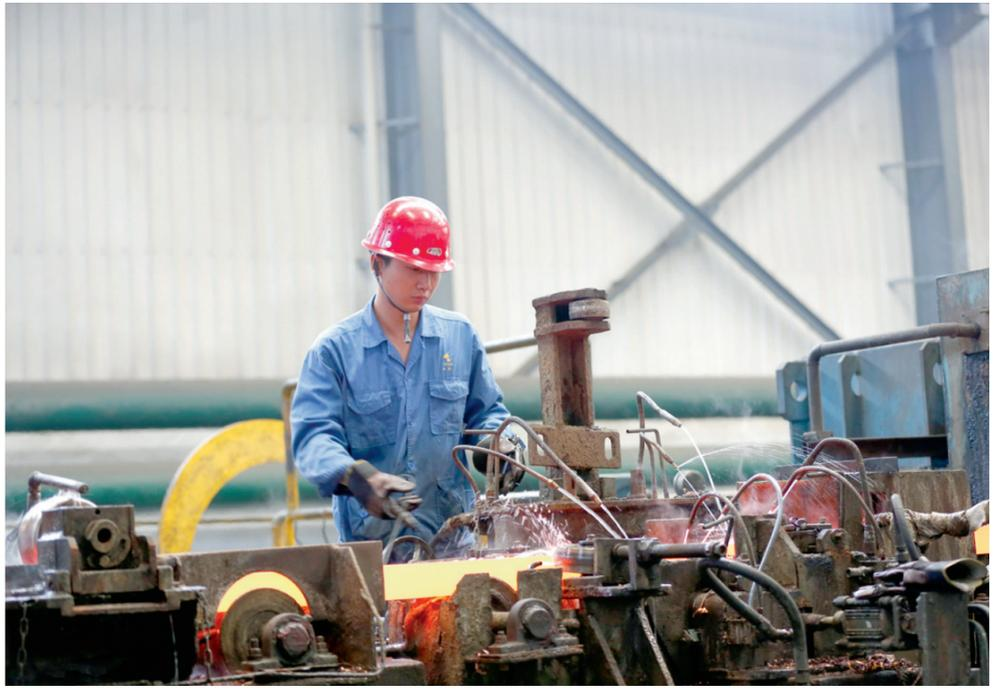
铜冠电工铜材公司以与先进企业对标为抓手,加强对铸机浇注速度和浇注铜液温度稳定的监控,及时调整优化工艺参数指标,在确保塔炉铜水质量的同时,通过梳理流铸、轧制工艺流程,找出降本增效的挖潜点,开展技术攻关,提升铜杆质量。图为该公司操作工正在监测铜铸杆出杆速度。 华伟 摄
