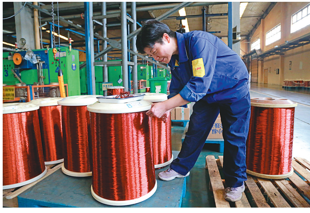
铜冠电工公司员工正在进行漆包线抽样检测。铜冠电工公司通过加大公司、分厂和班组三级工艺检查力度，发现产品质量问题及时反馈、调整，较好地减少了不合格品的产生。 王红平 华伟 摄
