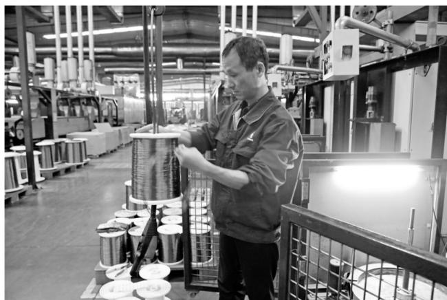
铜冠电工公司漆包线分厂员工正在取样。该分厂今年以来在漆包线生产中严格“三关”管理,把加强工序质量控制作为质量管理的着力点,严格把好质量领料关、制造关、移交关,较好地消除了质量隐患,使漆包线成品率达到了97.349%。
