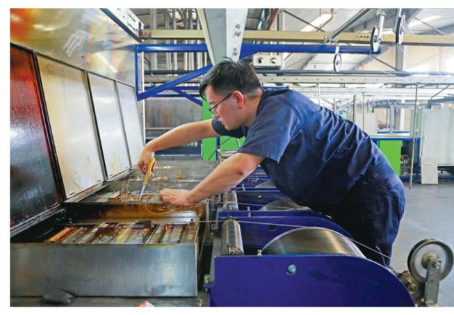
铜冠电工公司漆包线分厂员工正在调试铝漆包机生产线。铜冠电工公司根据铝漆包线市场需求,今年继续开展了部分闲置铜漆包机转铝漆包线生产的改造,截至到目前已完成15台铝漆包线的安装调试,业已投入生产的达到了10台,具备了3000吨的铝漆包线生产产能。
