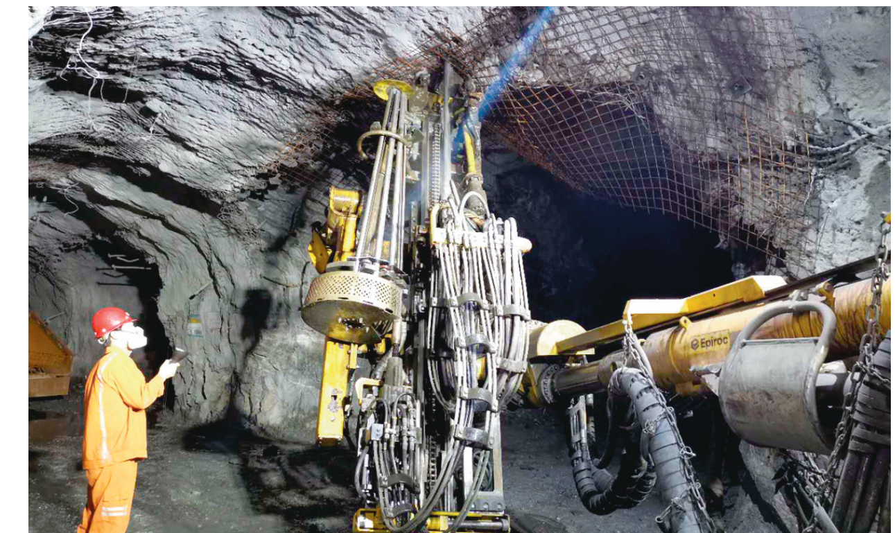
11月8日,冬瓜山铜矿掘进一区一线职工在井下负875米中段66-4号采场进行锚网支护。进入四季度,该区强化支护力量,并基本实现了人员网下作业,10月份共完成锚网支护808张、锚杆3766根,支护产量创单月新高,为矿山四季度及全年生产任务的完成提供了有力的安全保障。 王 文 摄
