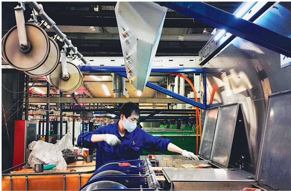
铜冠电工公司生产管理人员正在测试设备运转状况。铜冠电工公司坚持“全要素自主管控”核心理念,以管理创新、技术创新推进企业高质量发展,自对老式漆包机节能改造以来,对其关键设备进行了十几项技术改造,解决了由于设计、制造、安装等原因造成的运行中断线率高、能耗大等问题,并实现漆包设备高效低耗运行,为提升漆包线成本的竞争力起到积极作用。
