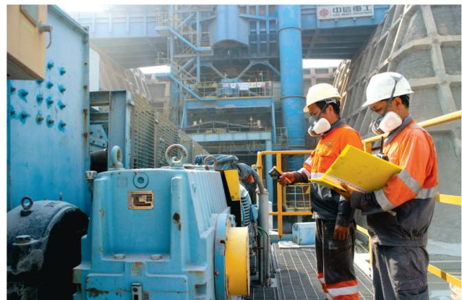
近来，凤凰山矿业(缅甸)公司结合当地形势，最大限度降低疫情对生产组织造成的影响，科学防控，以达产达效为目标抓工序衔接，1至4月份共完成破碎、运输、布料矿石441万吨，超业主生产计划量15万吨。图为员工们顶着40摄氏度的高温测量2号旋回破碎机给料胶驱动箱温度。何娇摄
