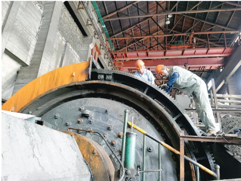
日前，天马山矿业公司选矿车间加强设备巡检维护力度，强化现场管理责任，确保生产过程中设备正常稳定。图为员工为5号球磨机齿轮进行检查。吴燕 王刚强 摄
