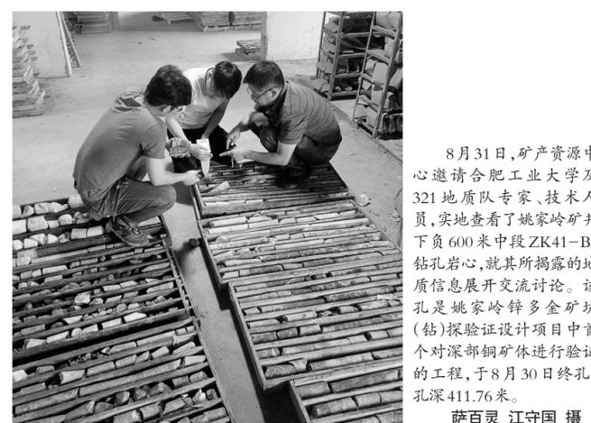
8月31日,矿产资源中心邀请合肥工业大学及321地质队专家、技术人员,实地查看了姚家岭矿井下负600米中段ZK41-B9钻孔岩心,就其所揭露的地质信息展开交流讨论。该孔是姚家岭锌多金属矿坑(钻)探验证设计项目中首个对深部矿体进行验证的工程,于8月30日终孔,孔深411.76米。
