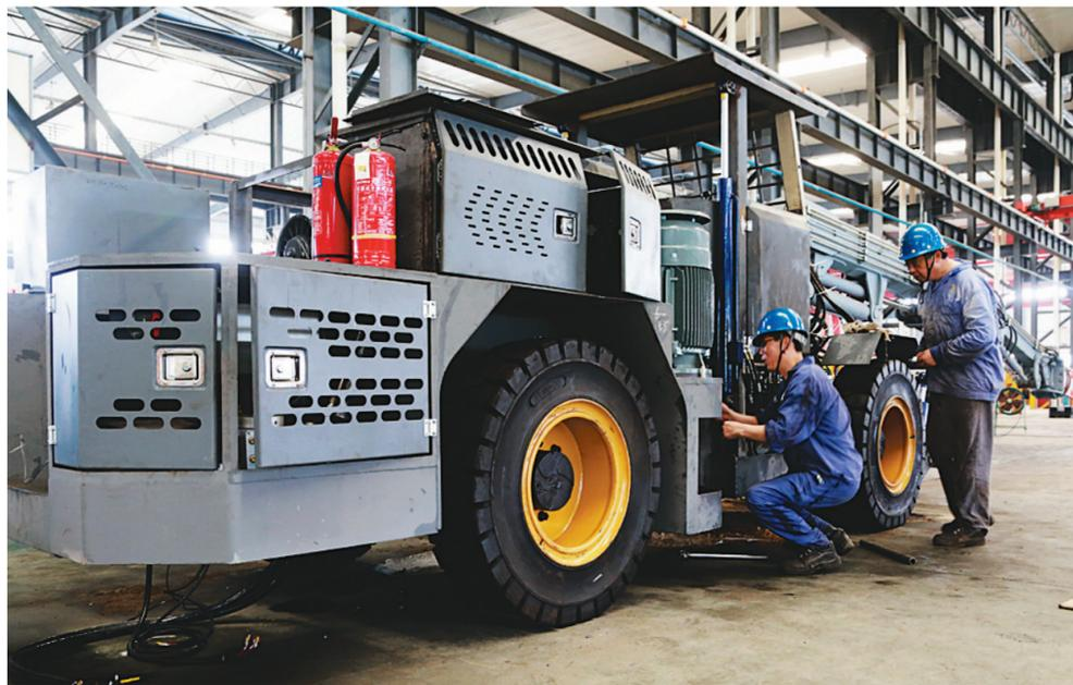
铜冠机械公司设备装配厂员工正在调试新产品撬锚台车。铜冠机械公司瞄准井下采掘作业安全要求越来越高,自动化机械需求增加的行情,积极加大了井下无轨设备新产品的研发工作。上半年,这个公司成功地研发出了井下使用的撬锚台车,目前,车已完成组装,进入了调试阶段。
