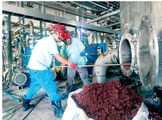
日前,为进一步提高优质的铜箔产品,提升电解液纯度,铜陵铜箔公司溶铜工段顶着高温对溶铜罐底进行清扫工作。据悉,溶铜工段共有12个溶铜罐,为了保证硫酸铜不结晶,溶铜罐底部都是由不到1米高的镂空板隔开,日常罐体内温度控制在50摄氏度以上。图为这个公司溶铜工段溶铜工正在清理罐底。陈幸欣 刘汤青 摄
