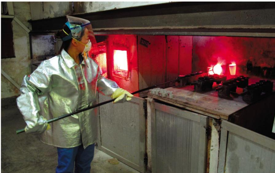
8月11日,检测研究中心试金女工正在1100摄氏度高温下的试金炉前进行作业。高温试金炉是试金分析的主阵地,1100摄氏度的高温将整个工作场所烘烤到40摄氏度以上。检测人员要穿戴劳动保护用具,工作服是湿了又干,干了又湿。为保证酷暑时期产品检测质量、进度,一群铿锵玫瑰们责无旁贷坚守在“火烤”阵地上,无怨无悔。
