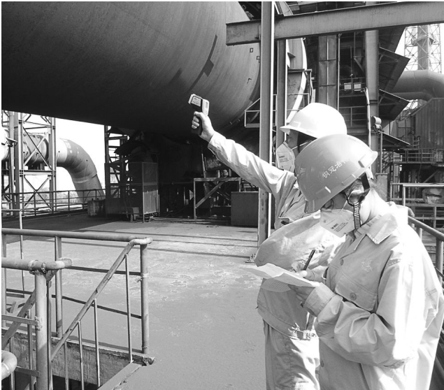
7 月 31 日，铜冠冶化分公司工艺点检员正在用红外线测温仪测量回转窑窑体温度。该公司为防止高温下设备系统“中暑”，严格加强设备点检、润滑和预防性维修，提高设备管理水平，确保设备安全“度夏”。方威达 胡永斌 摄
