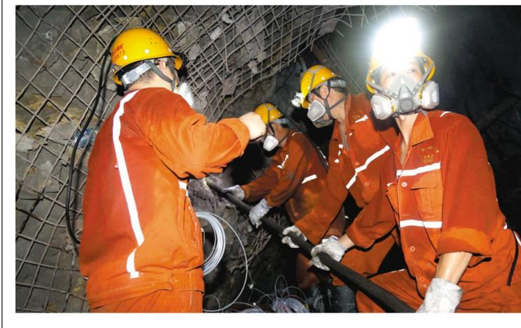
8月2日上午,全国有色行业系统模范班组冬瓜山铜矿采矿业区采矿业,在负850米58-23号采场正在进行中孔扩槽大爆破准备。该区采矿业区克服采场温度高、作业环境差,挥汗如雨、不畏艰辛,圆满完成当天大爆破装药任务。今年1至7月份,该区采矿业区共进行大小爆破280次,炸药量585吨,采矿量达175万吨。
