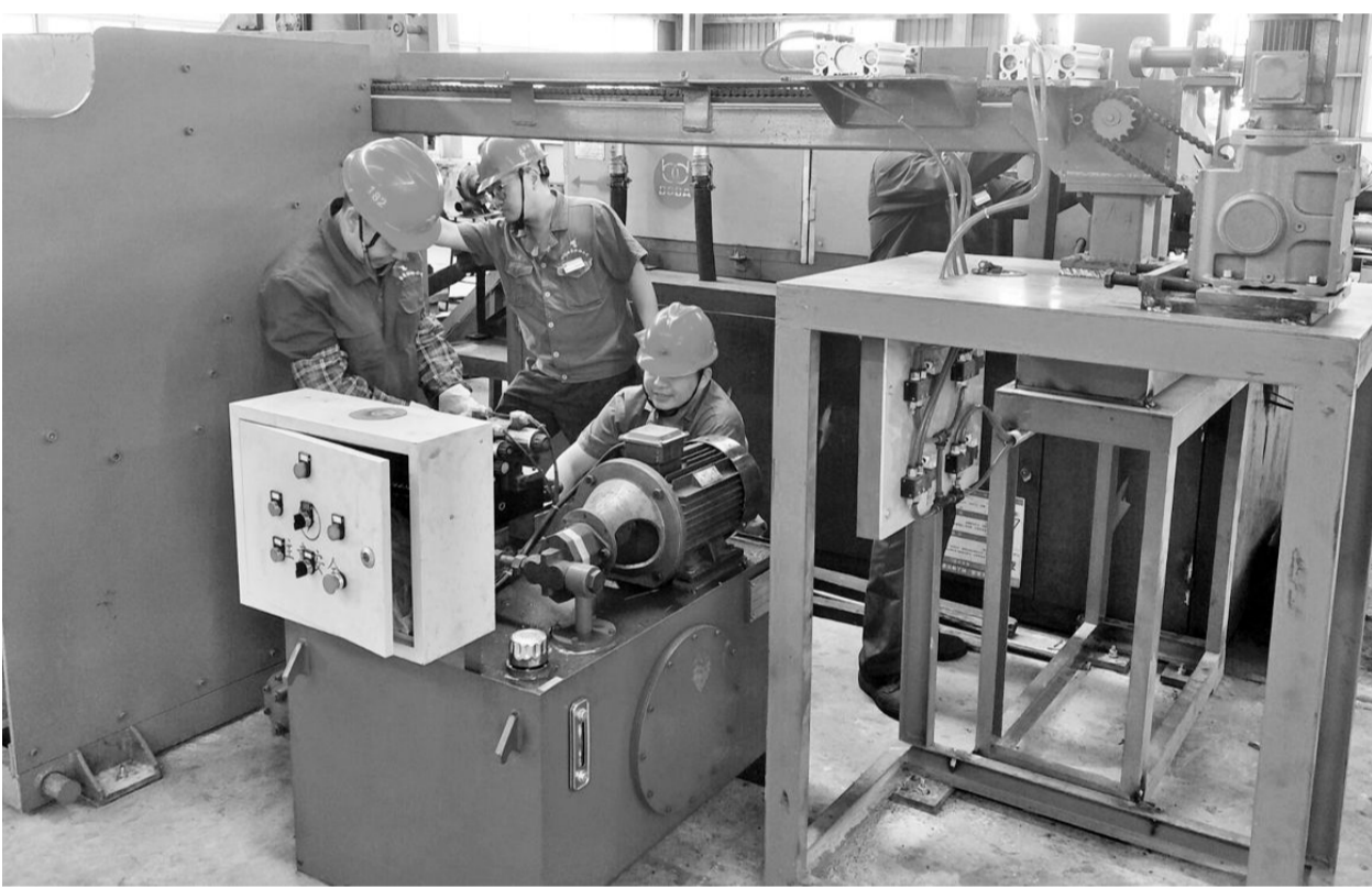
金神耐磨材料公司职工日前正在技改施工。为减轻工人劳动强度,提高生产效率,金神耐磨材料公司对锻造生产线加料系统成功进行了设备自动化改造,使企业设备自动化程度进一步提升。 王红平 徐金鑫 摄
