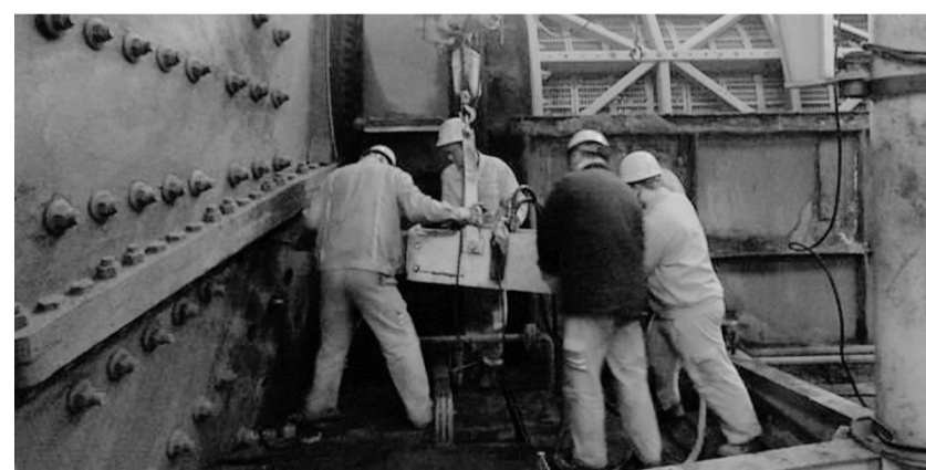
日前,冬瓜山铜矿选矿车间职工利用螺栓冲对半自磨衬板螺栓进行拆除。新年伊始,这个矿对选矿设备进行为期两天的检修,进一步提高设备运转率,保障矿山生产稳定高效。 刘 晨 摄
