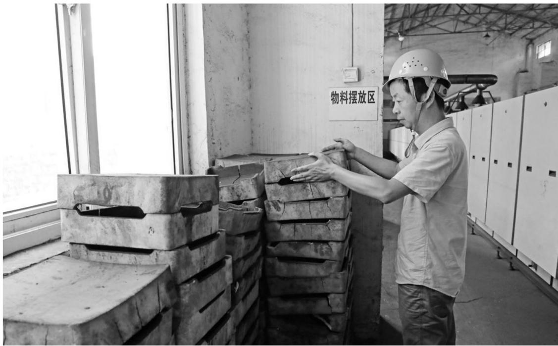
金泰电池公司职工日前正在整理烧钵。金泰电池公司在挖潜降耗中,在加大生产过程控制,减少返工浪费的同时,正对生产中低值易耗品烧钵使用量大的特点,采购时从性价比方面进行综合遴选采购,较好地降低了采购费用,降低了生产成本。
