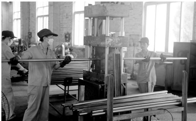
冬瓜山铜矿动力车间加工班树立“以安全生产为中心,以职工健康为根本”的责任意识,通过改善作业环境,调动职工积极性,有效地提高了锚杆生产量,从原来单日产量1200套突破至1800套,大大提升了井下挂网支护的进度,为安全生产提供了有利的支撑。图为该班女工正在操作压管机。
