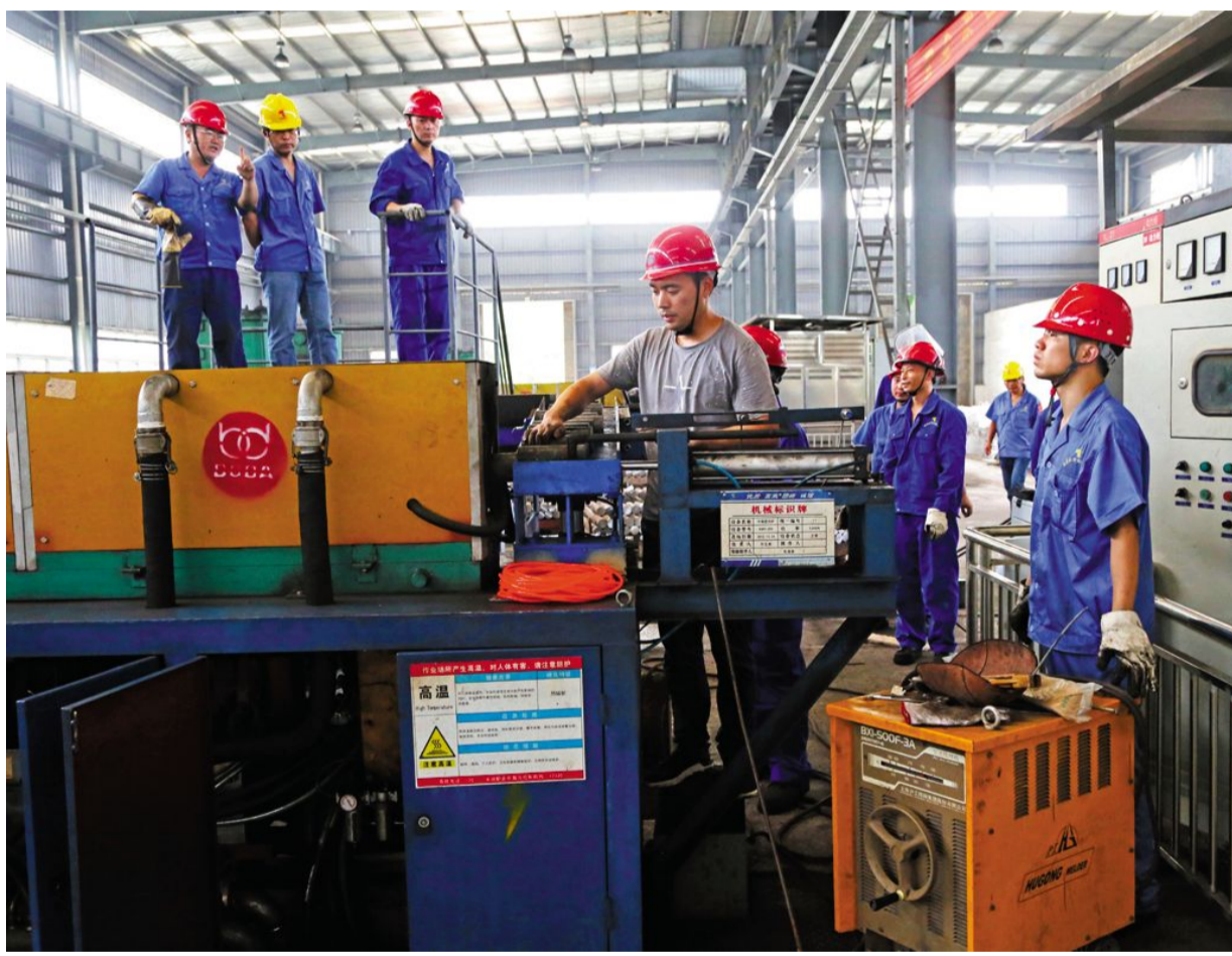
铜冠投资金神耐磨材料公司职工正在调试新上搓板自动上料系统。铜冠投资金神耐磨材料公司日前引进了一套用于球磨生产的搓板自动上料系统，该系统将过去的球磨生产由人工上料变成了机械自动上料，提高了生产效率，降低了人工劳动强度。目前该系统正在调试，待投入生产正常后，下一步将推广到所有球磨生产线。王红平 王强 摄
