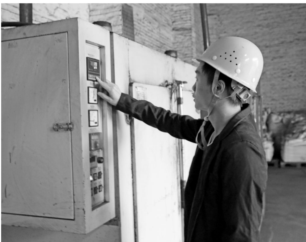
10月25日,铜冠投资金泰电池公司在进行烘干作业。铜冠投资金泰电池公司针对生产中电池表面脏污难清洗及烘干效率低的症结,组织技术攻关,通过对烘干设备技术改造,大大提高了电池清洗效果和烘干效率,同时还降低了电耗。日前,这项技术改造成果获得了国家实用新型专利。
