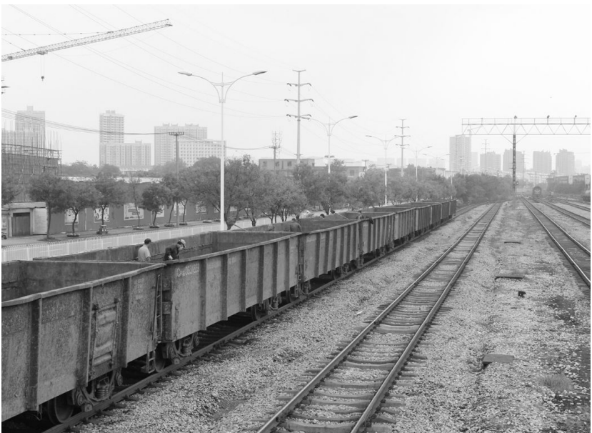
日前,铜冠物流金铁分公司余家村站第十三股道线上,几名工人们正在清除存放在此处的13辆IC车内部的沉淀物(如图),目的是为了便于IC车辆委外维修工作。据了解,该分公司共有34辆IC车,主要用于冬瓜山铜矿外发硫精砂铁路运输任务。为确保IC车辆铁路运输安全,该分公司严格按照国家铁路局车辆修程周期要求,分批次将IC车辆委外维修。年内,余下的11辆IC车也将整装赴外维修,届时,该分公司34辆IC车全部完成修程周期。 邹卫东 摄
