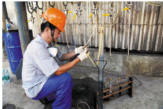
金昌冶炼厂职工日前正在硫酸生产系统前作烟气检测。金昌冶炼厂围绕“高空达标,低空受控”的烟气排放目标,深入开展了治理和改善烟气低空污染攻关活动,同时加大了对硫酸系统烟气转化率检测工作,每天对每个硫酸系统进行烟气检测,为硫酸生产和环保控制提供了可靠参数。王红平 齐宏明 摄
