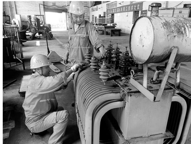
冬瓜山铜矿动力车间积极做好挖潜增效工作,以持续开展修旧利废工作为载体,秉承勤俭节约的良好作风,让节约成为员工的习惯,不仅给企业节约了成本,还使员工的技能水平在实践中得以迅速提升。图为该车间组织人员对发生故障的315千伏安电力变压器进行修复。
