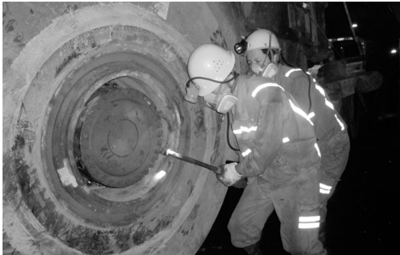
今年一季度, 冬瓜山铜矿采矿区出矿班91名员工凭着精细化的管理, 不仅使出矿铲运机轮胎成本下降21.2万元, 而且完成了75.08万吨的出矿量。图为日前在井下负800米两名员工正在紧固轮轴螺栓。
