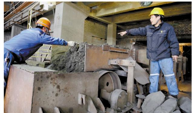
2月26日上午,安庆铜矿选矿车间破碎皮带工正在对井下提升上来的矿石进行分检,防止掺杂的杂物进入破碎系统影响到设备安全和产品质量。据了解,该矿将产品质量作为开拓市场的重要保障,强化生产过程中各个环节的管理,保证产品质量稳中有升,确保在市场上的良好信誉。
