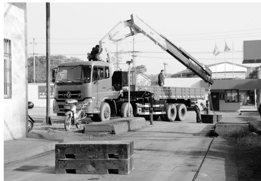
为保证 80 吨地磅计量数据的准确性,规范铜、铁精砂产品运输,防止途损,2 月 18 日下午,安庆铜矿邀请安庆市质量技术监督局计量测试所来该矿地磅进行标定校验。经校验,消除了地磅系统偏差,提高了精准度。图为工作人员正在校验地磅。
