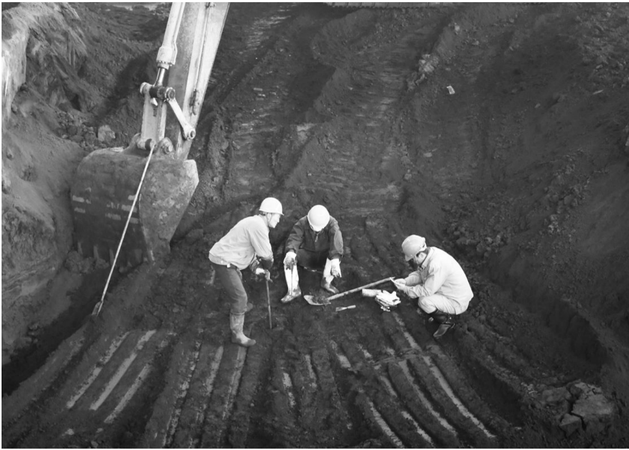
稀贵金属分公司铜精矿矿仓内职工正在取样。近年来,经过不断实践、摸索,稀贵金属分公司渣选矿转渣选系统回收率等各项选矿指标逐步得到优化,但较高的磨矿细度保证了浮选指标,造成精矿产品水分居高不下。为此,分公司一方面组织有关人员进行技术攻关,一面加强了对铜精矿取样检测,以确保产品正常销售。
