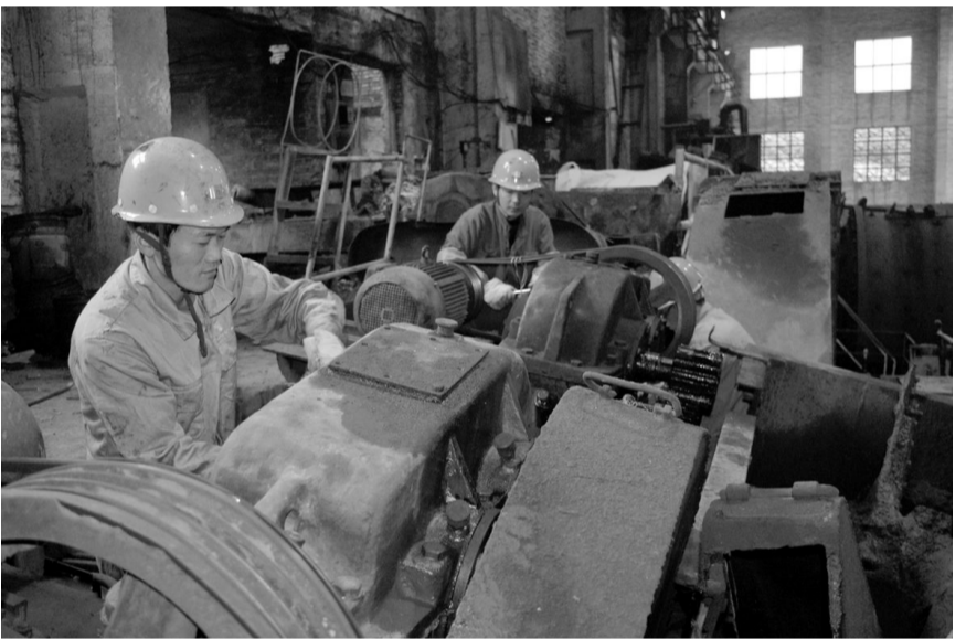
日前,天马山矿业公司金口岭选矿车间利用年终停产检修时间,组织职工对0号球磨机减速机进行检修,顺利完成了箱体螺栓的更换紧固工作,为车间安全生产提供保障。 朱艳 侯晓琳 摄
