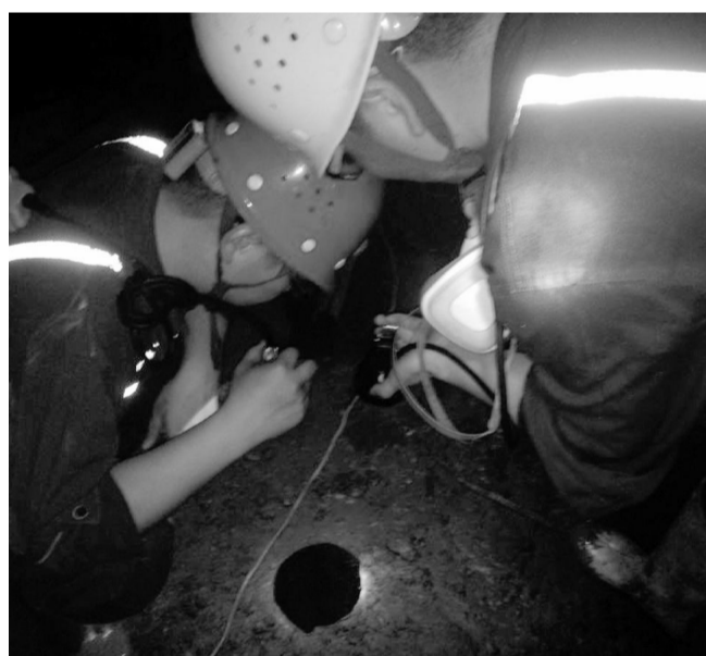
“五一”劳动节,铜冠矿业公司安钢项目部采矿工区的职工们坚守岗位,用劳动庆祝自己的节日。该工区大部分职工都是近年来新引进的大学生,如今,这些年轻人已熟练地掌握了采矿施工的各道工序,自主采矿能力得到不断提升。图为大学生员工在爆破后查看炮孔是否通孔。陶莉 张亚锋 摄
