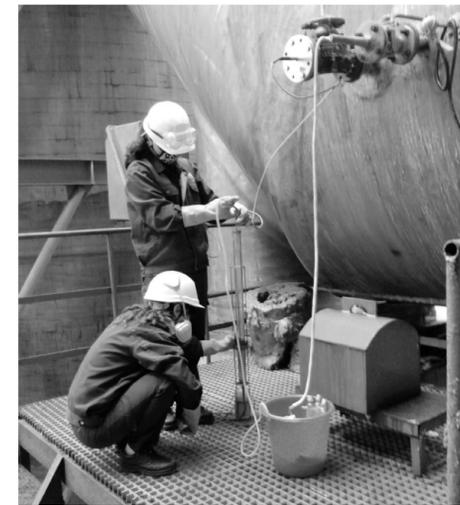
铜冠冶化分公司不断增强安全环保“红线”意识,强化责任落实,提升环保监测能力,做到不安全不生产,环保不达标不生产。该公司综合车间针对球团尾气脱硫系统使用的胺液改为国产,胺液浓度的检测方法也随之改变的现状,大胆创新,对球团尾气脱硫等环保指标进行实时检测,为公司严把环保关提供及时、准确的分析数据。图为化验工正在现场提取试样。
