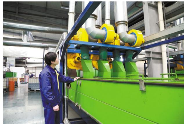
铜冠电工公司职工日前在生产中巡查第一台改造好的高速卧式漆包机冷却系统运转情况。该公司针对高速卧式漆包机冷却系统存在能耗大,故障多的弊端,发起技术攻关,成功地完成了1台高速卧式漆包机合理化技术改造。通过技术改造,单头冷却功率由8.7千瓦降低到2.6千瓦,1台高速卧式漆包机一年节约电费98000元。下一步,待26台高速卧式漆包机全部完成改造,年节约电费将达200多万元。
