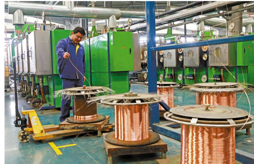
铜冠矿建公司职工目前正在拉线机前放线作业。铜冠矿建公司近期积极启动了供应商质量提升计划,一方面围绕客户投诉、内部自查发现的质量异常问题,提出相应整改措施,加大对加工设备等投入,提升硬件水平;另一方面着力提升人员技能,加大生产现场管理力度,提升环境水平。 王红平 芦广胜 摄
