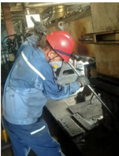
炭素事业部成型一车间员工冒着高温清理混捏机下料口管壁的粘结料。
