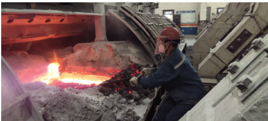
在电解现场,一名电解工正在打捞槽内结壳块。
