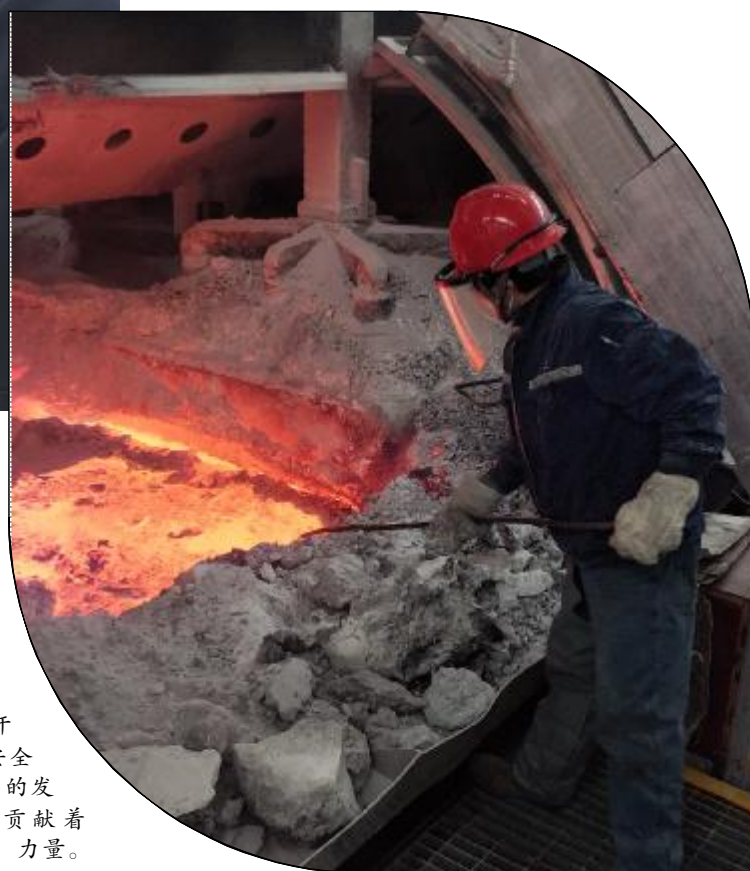
电解工正在检查炉底
