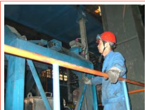
上图 一组装车间员工罗春红发现石墨夹持装置易卡死, 拉坏链条。他建议取消夹持, 安装阻挡, 实施后效果较好...
