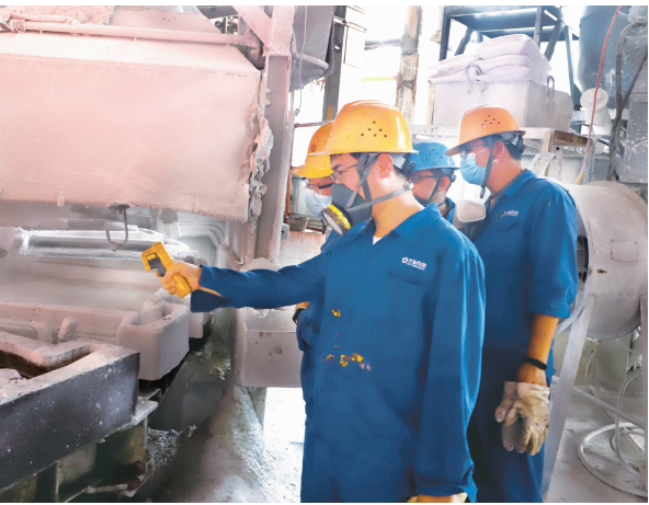
职工测量铜模温度,提高产品合格率。
