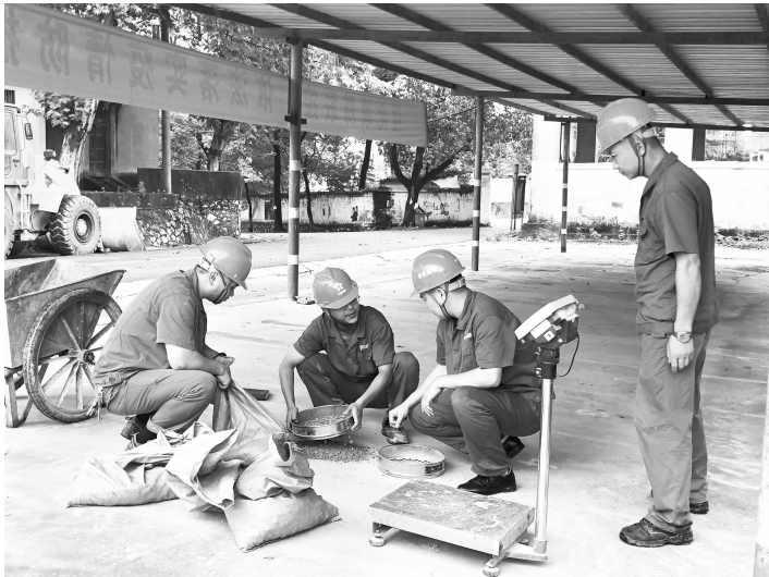
▲党员对矿石样本进行筛析，研究矿石粒度对浮选效率的影响。
