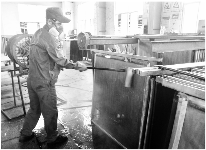
▶给钛板表面涂沫盐酸，清除表面氧化物。
