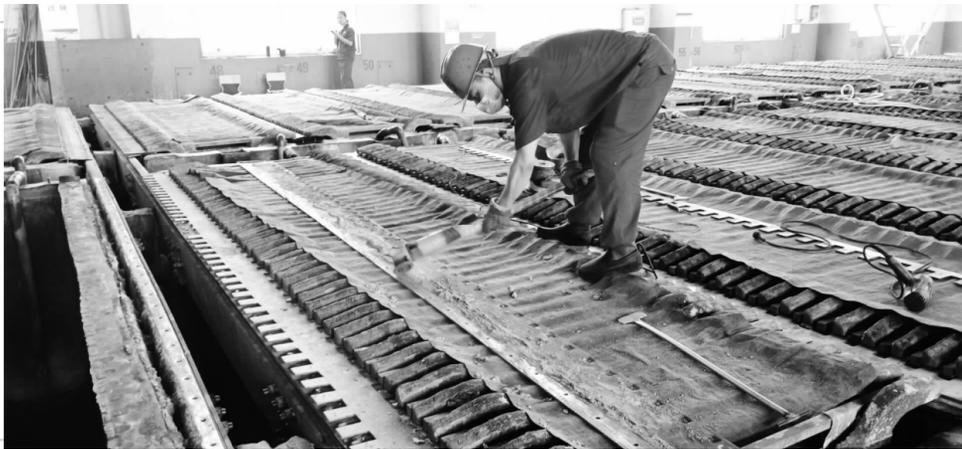
职工在打磨母线边排,减少电能损耗。张振武摄
