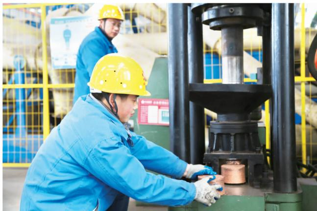
职工利用废旧电器产品拆解后的铜线制作铜饼。
