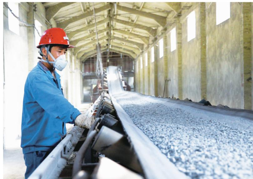
▲职工在调节皮带托辊,保障设备设施高效安全运行。
