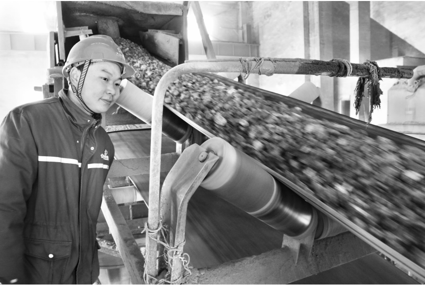
▲ 职工汪桥检查B3皮带给矿漏斗下矿情况。
