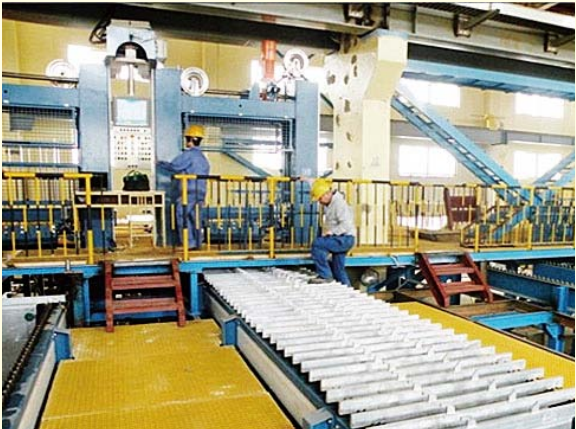
驰宏会泽16万吨项目——锌系统 ——比利时工程师调试自动剥锌机
