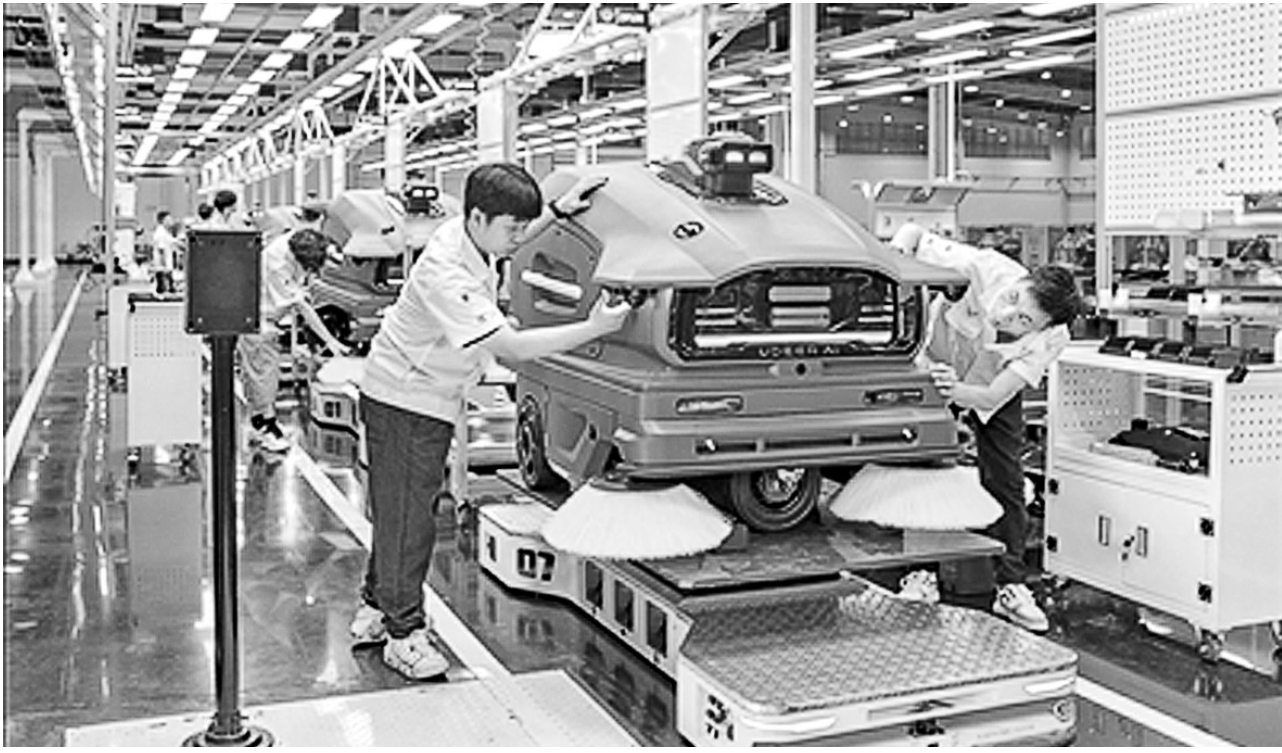
7月28日,浙江省金华市一家企业的生产车间内,技术人员对即将下线的巡扫机器人进行检查。该巡扫机器人由企业与人机科技公司联合研发,双方协作攻关产业化难题,推进了量产。 陈业摄
