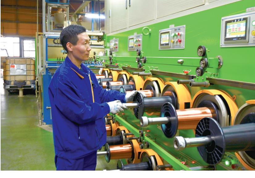
日前,铜冠电务工湖公司员工正在生产漆包线。该公司聚焦生产痛点,扎实推进技术改造与工艺升级,顺利完成细微线车间单头漆包机技改升级。目前,设备已完成调试并投入运行,各项工艺参数运行平稳,产品质量符合汽车类客户供货标准。 通讯员 方宇星 摄
