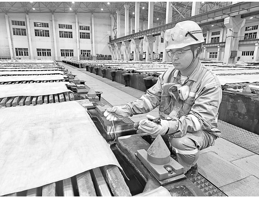
图为管家虎在电解槽检测电解液温度。
